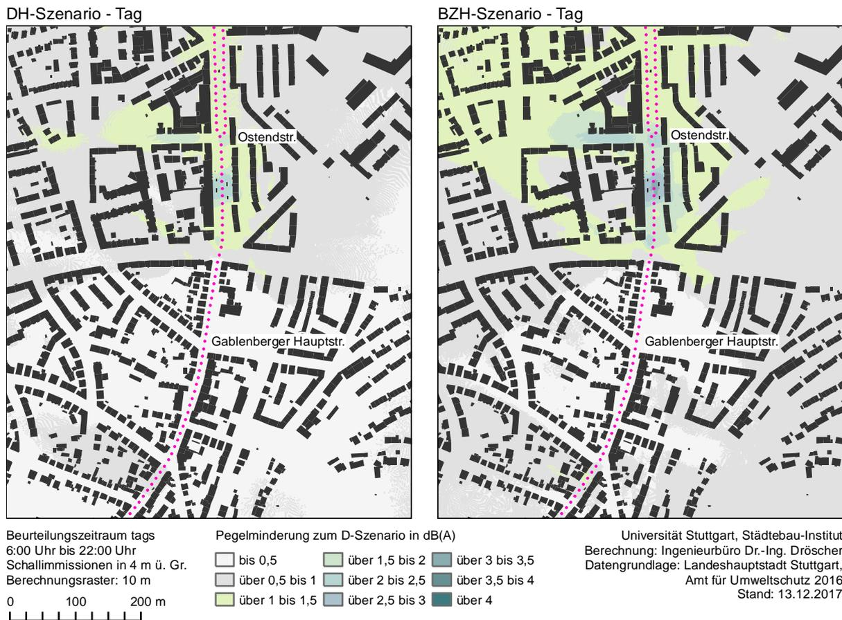
Abb. 18: Minderung der Schallimmissionen im Straßenverkehr im Untersuchungsgebiet Ost (Ausschnitt) tagsüber durch den Einsatz von DH-Bussen (links) und BZH-Bussen (rechts) gegenüber dem Basis-Szenario mit Diesellbussen.
