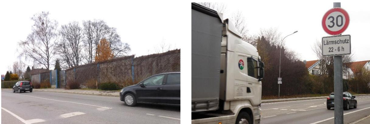
Abb. 2: Maßnahmen zum Lärmschutz: Lärmschutzwand und Tempolimit nachts in Friedrichshafen.
